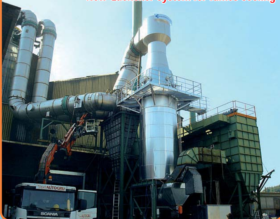
Combustore rigenerativo a 3 camere abbattimento SOV 3 chambers regenerative combustion plant for VOC treatment
